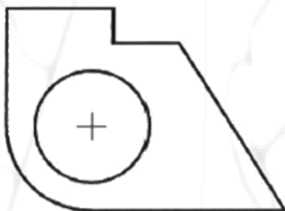
Figuur 35 - Plaatsen van een centrum markering.
