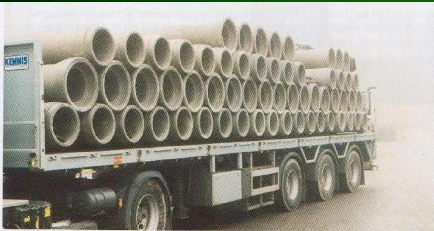
Deze rioolbuizen zijn zijwaarts niet gezekerd. Een dergelijke lading vormt een potentieel gevaar voor andere weggebruikers.
