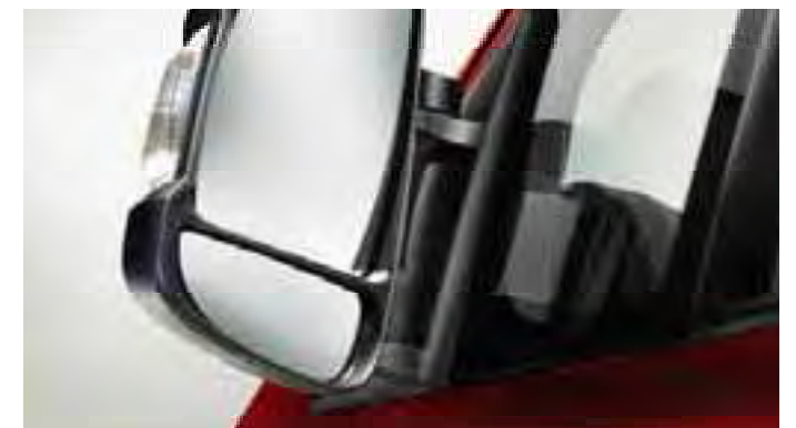
De richtingaanwijzers zitten geïntegreerd in de zijspiegels. Het reflecterende gedeelte heeft een dubbele parabool om de zichtbaarheid te verbeteren.
