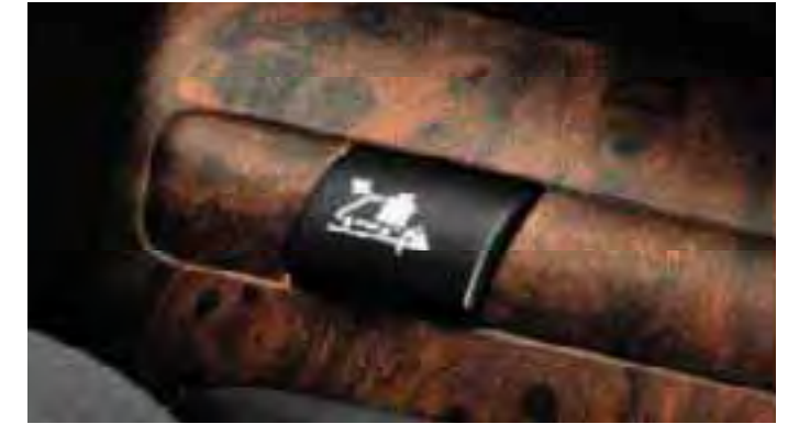
Knop van de Up- functie op het dashboard voor een optimalisatie van het schakelen met een volgeladen voertuig.
