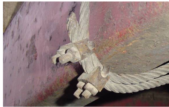
Schroefklemmen mogen niet gebruikt worden
