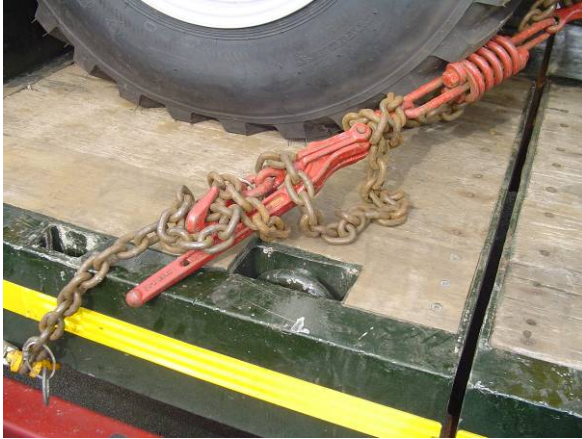
Spanelement met meer dan 15 cm terugslag Te gevaarlijk en daarom dus verboden
