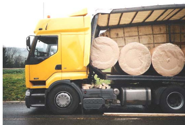
De Kopschot weerstaat niet alle belastingen
