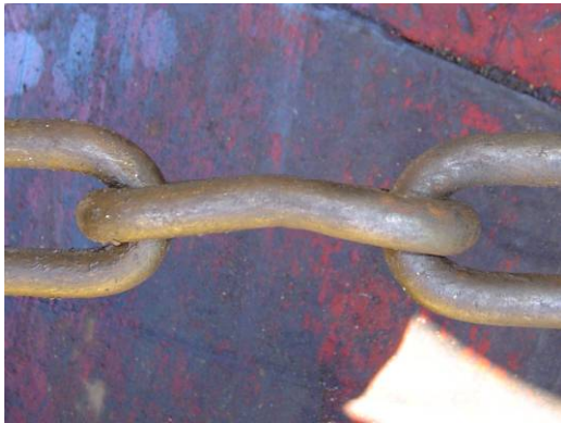
Kettingschakels zijn verbogen
