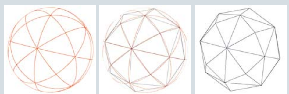
De sfeervolle oplossing voor de bedekking van de bollen van het Atomium: 48 sferische driehoeken afgelijnd door 9 grote cirkels (links). Het volume komt overeen met een opgeblazen 'disdyakis dodecahedron' (rechts).
